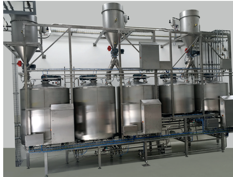
Vorteig-Anlage in einer Großbäckerei.
